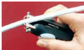
KIT.REG : permet la lecture directe de la longueur de dénudage
